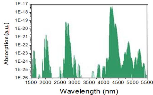
*Figuur 1: De absorptie van  $CO_2$  in functie van golflengte. De absorptie bij langere golflengtes is grootteordes sterker dan bij 1550 nm.*
