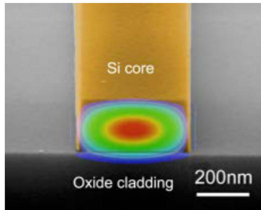
*Figuur 2: Een rasterelektronenmicroscopie foto van een silicium optische golfgeleider. Door het grote indexcontrast tussen het silicium en zijn omgeving zit het licht samengepakt in een heel kleine doorsnede. De optische mode is gesuperponeerd op de foto. Foto uit [1]*
