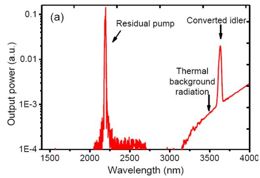
*Figuur 4: Het uitgangsspectrum van een mid-infrarood lichtgenerator. Door het mixing van een krachtige pomp (20 W piek vermogen, 2 ps lange pulsen) met een continu telecommunicatiesignaal bij 1565 nm wordt licht bij 3630 nm gegenereerd.*
