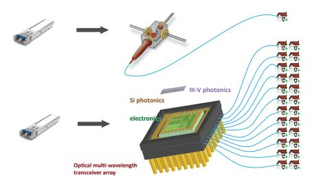
Figuur 1: SFP behuizing die een enkele FTTH transceiver bevat en gebaseerd is op discrete optica (bovenaan) en een SFP behuizing die 24 transceivers bevat door middel van geïntegreerde optica op een silicium chip (onderaan).
