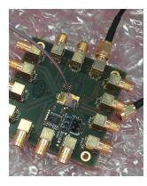
Figuur 2: 4-kanaals FTTH transceiver demonstrator, gerealizeerd in samenwerking met Genexis, Caliopa en de Technische Universiteit van Eindhoven in het kader van het Nederlands Smartmix-Memphis project.
