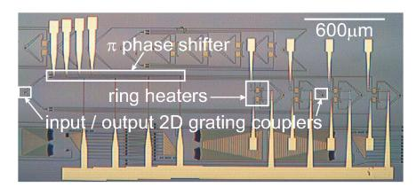
Figuur 4: Microscoopfoto van een gefabriceerde silicium chip met FlexPON golflengterouter.
