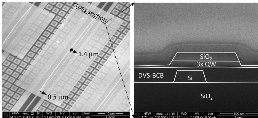
**Figuur 2:** SEM opname van membraam golfgeleider en doorsnede door de taper sectie.
