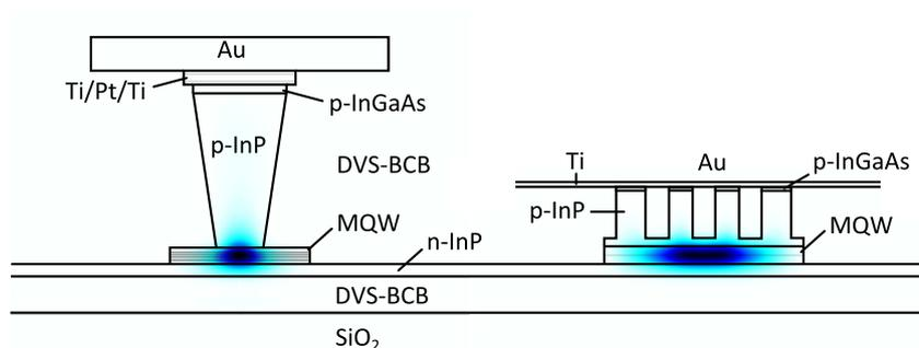
**Figuur 1:** Voorgestelde elektrisch geïntegreerde golfgeleiders: de V-golfgeleider (links) and the galerij golfgeleider (rechts).
