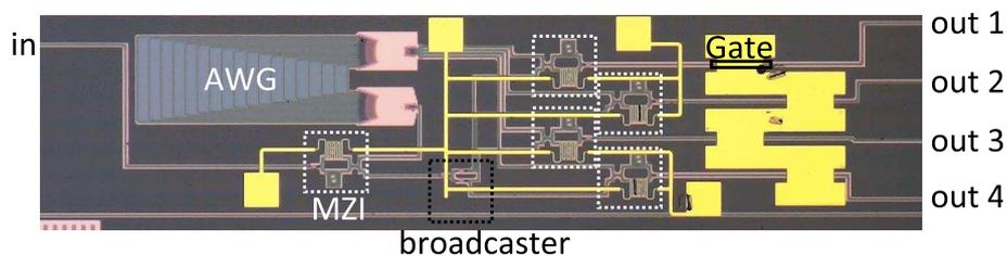
**Figuur 3:** Optische microscopie opname van een gefabriceerde 1x4 schakelaar.
